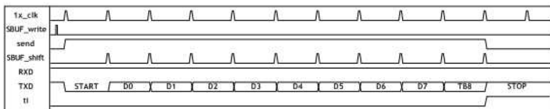
图6.10 UART模式3的传输时序图
