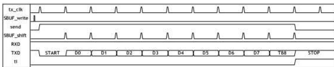
图6.9 UART模式2的传输时序图
